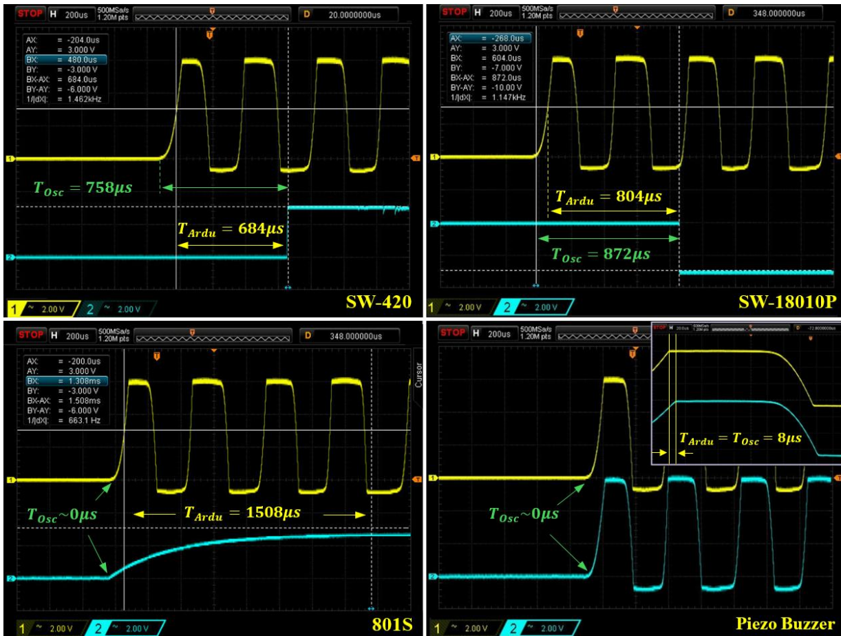
Figura B2: Tempos de resposta de sensores digitais, curva azul claro, em relação ao sensor de referência, curva amarela, o piezo buzzer.
