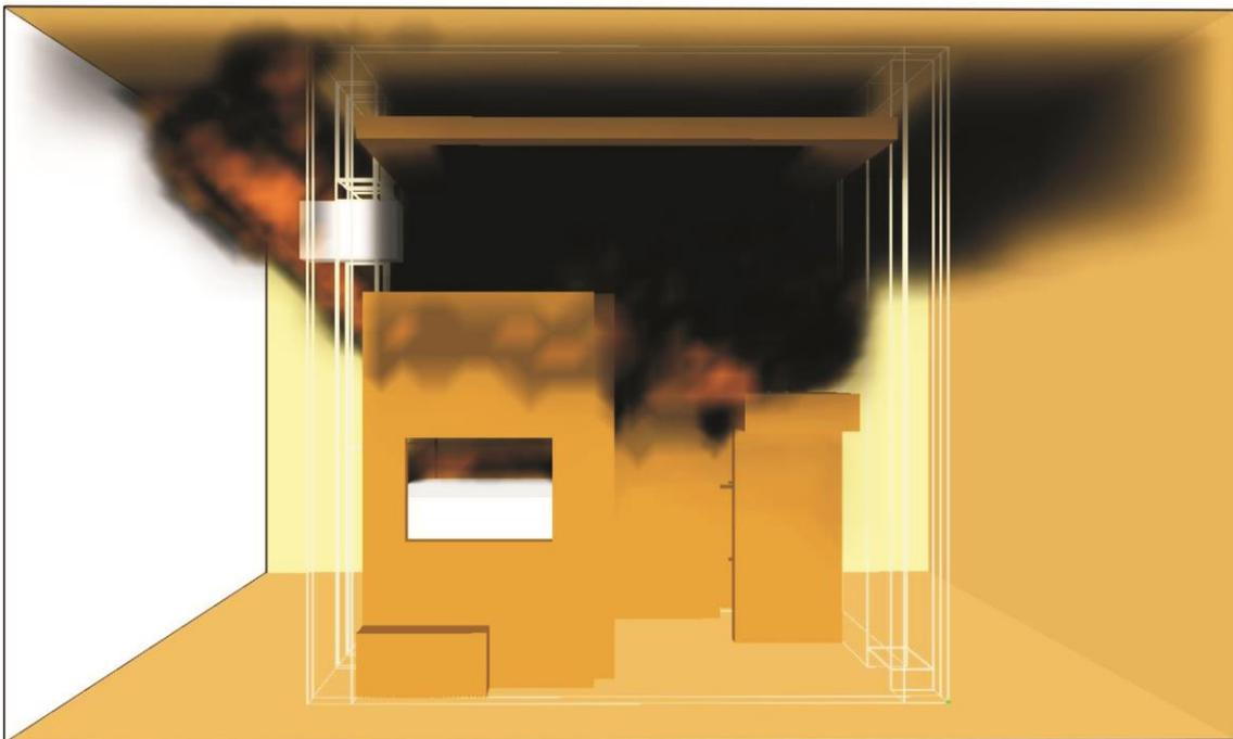
**Figura 10S.** Vista Lateral Esquerda – ( $T = 330\text{ s}$ ) – Início da queima do colchão da cama inferior
