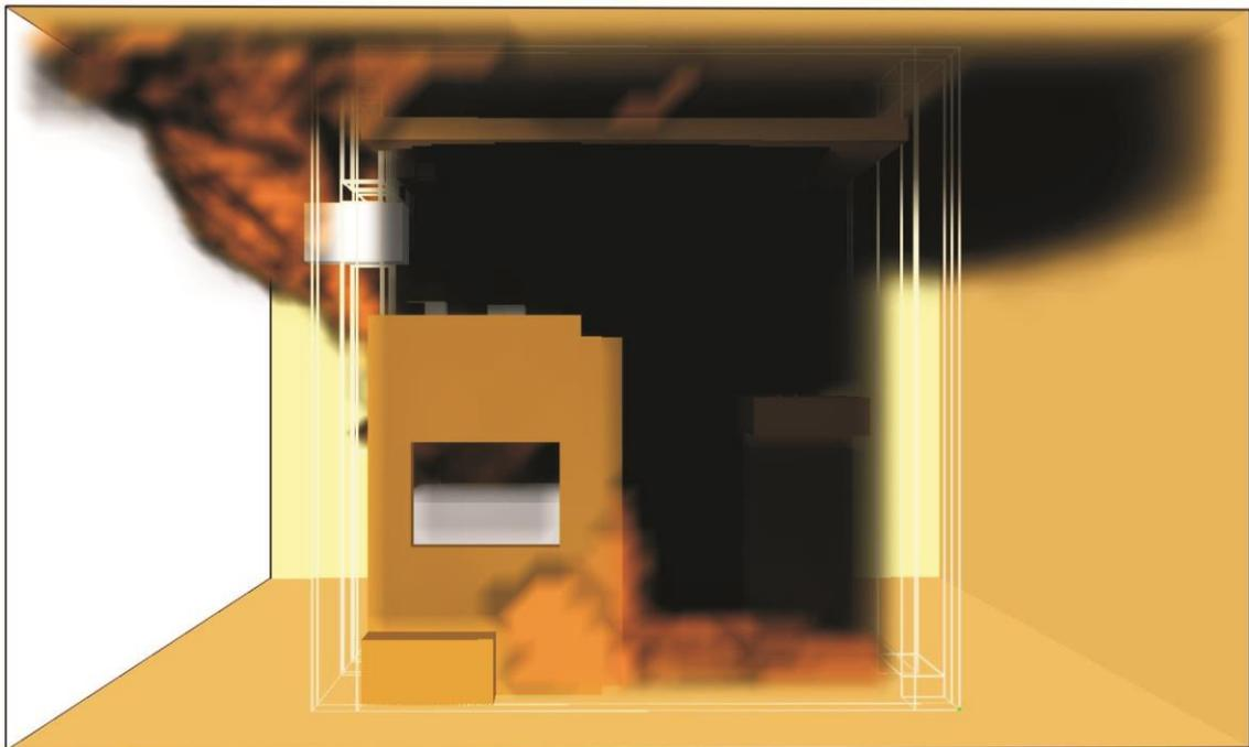
**Figura 12S.** Vista Lateral Esquerda – ( $T = 420$  s) – Foco limitado pela ventilação, mantendo-se intenso na região que compreende a abertura inferior da porta e a região da janela
